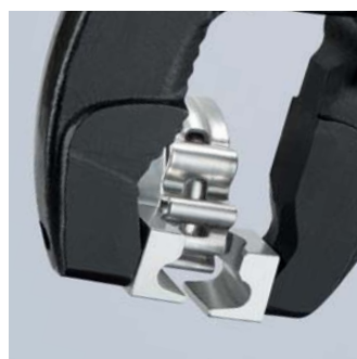
Apertura di una fascetta stringitubo con battuta
