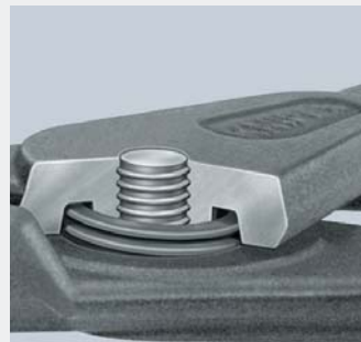
Molla interna: posizione protetta dentro la precisa articolazione a vite. Non ostacola il lavoro, non si sporca e non si perde
