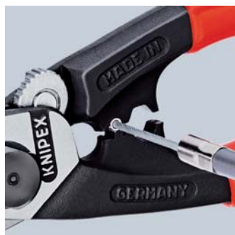
Crimpaggio del terminale sulla fune metallica
